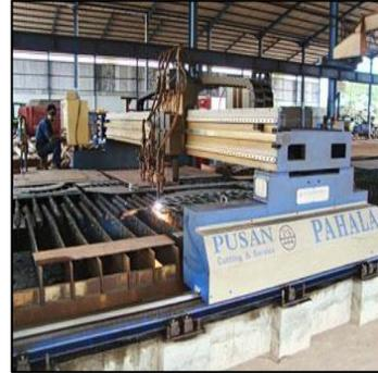
Gambar 1.12 Mesin *Cutting* CNC
