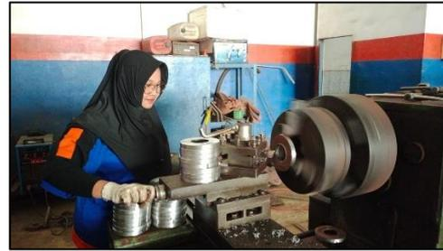
Gambar 2.4 Pembubutan Facing *Flange*
