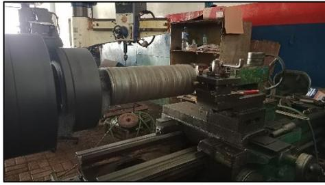
Gambar 2.3 Pembubutan Panjang Diameter *Flange*
