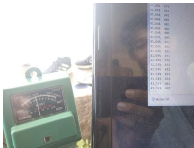
Gambar 4.7 Pengukuran tanah kering
