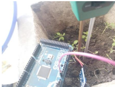
Gambar 4.6 Pengukuran kelembaban tanah
