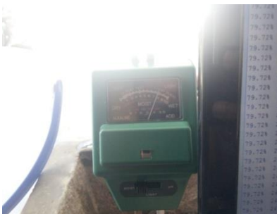
Gambar 4.8 Pengukuran tanah sedang
