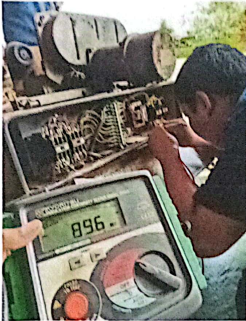
Gambar1.31 Meger Test Hoist Crane
