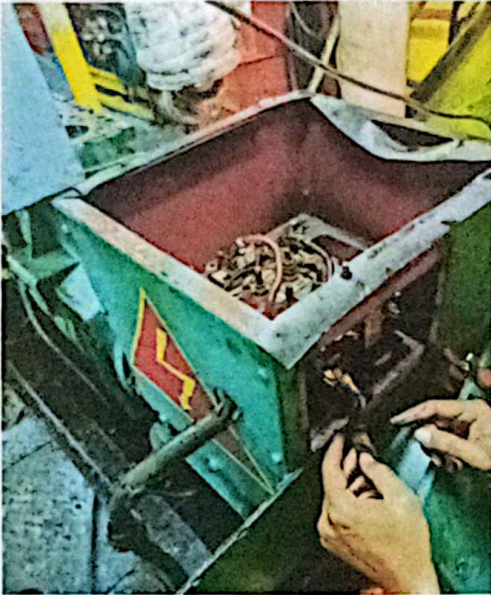
Gambar1.23 Meger Test Motor Listrik di Kapal KMP Gorare
