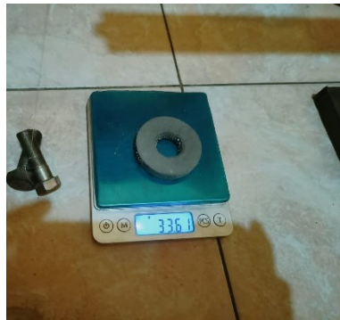
Gambar 4. 13 Prosedur Menimbang Spesimen Kering
