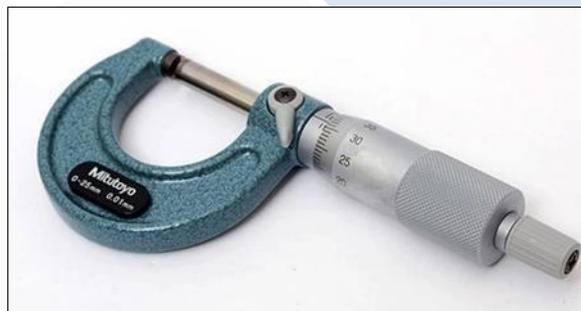
Gambar 3. 3 Mikrometer Luar Ket. 0,001 mm
