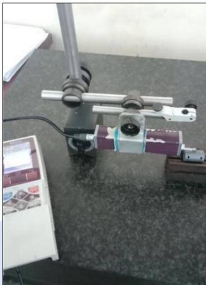
Gambar 3. 17 Proses Pengujian Kekasaran Permukaan dengan *Surface Roughness Tester*
