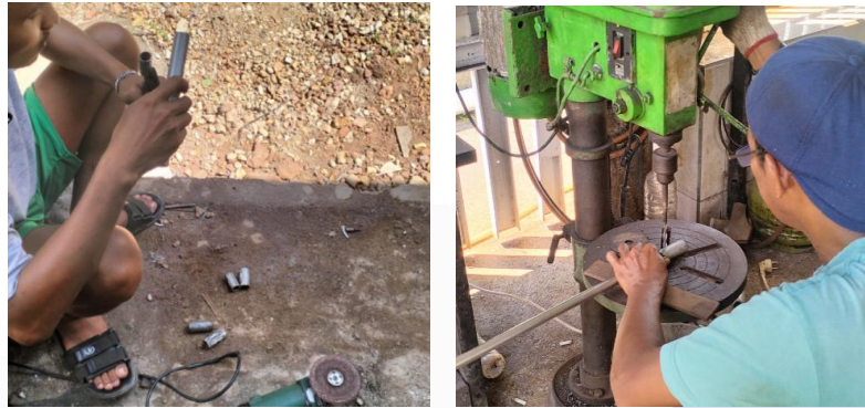
Gambar 4.24 Pembuatan poros pengaduk
