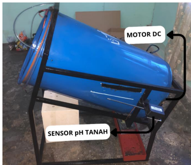
Gambar 4. 3 Peletakan Sensor pH Tanah dan Motor DC
