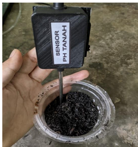
Gambar 4. 8 Gambar Pengujian Sensor pH Tanah
