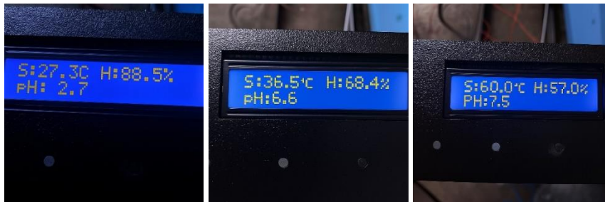
Gambar 4. 13 Tampilan Hasil Pengujian Keseluruhan Sistem dan Alat di LCD
