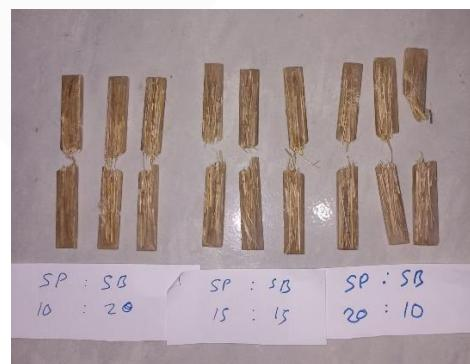
Gambar 4.6 Hasil Pengujian Spesimen Impak
