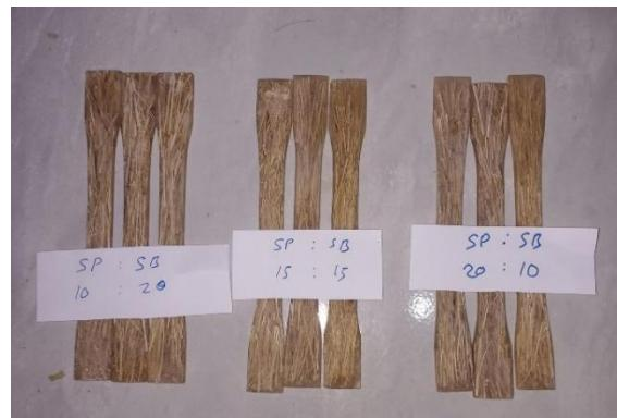
Gambar 4.1 Spesimen Uji Tarik
