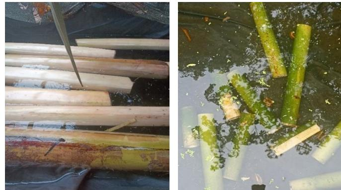
Gambar 3.18 Perendaman Lapisan Pisang dan Batang Bambu
