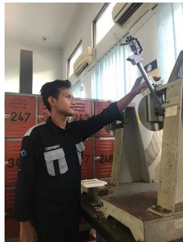
Gambar 4.5 Proses Pemasangan Spesimen Pengujian Impak
