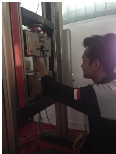
Gambar 4.3 Proses Pemasangan Spesimen Pengujian Tarik
