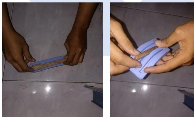
Gambar 3.26 Pelepasan Komposit Dari Cetakan
