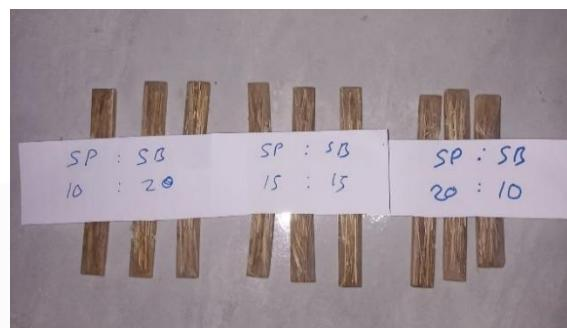
Gambar 4.2 Spesimen Uji Impak
