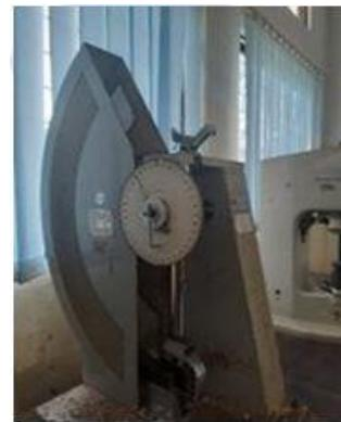
Gambar 3.15 Alat Uji Impak
