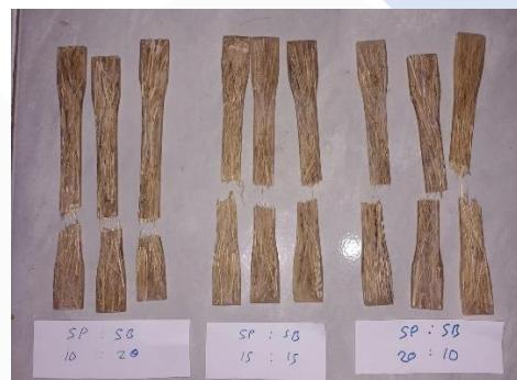
Gambar 4.4 Hasil Pengujian Spesimen Tarik
