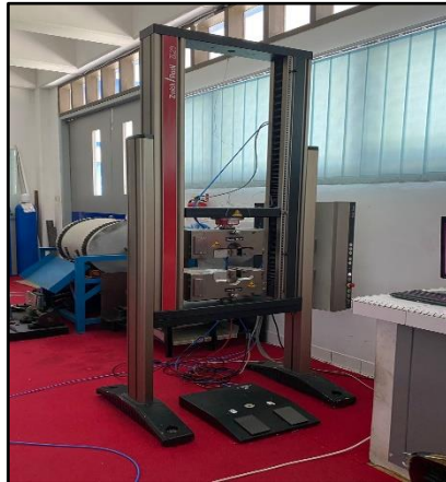
Gambar 3. 5 Alat Pengujian Tarik
