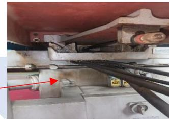
*Gambar 1. 3 Kerusakan rubber dumper pada sumbu X*
