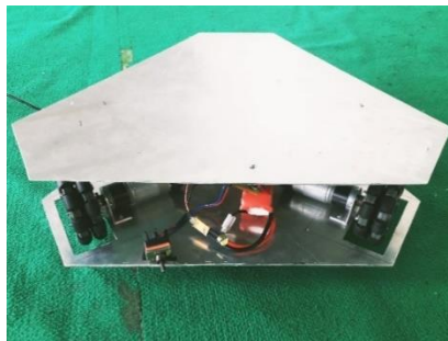
Gambar 4.9 Assembling Mekanik dan Elektrik Robot
