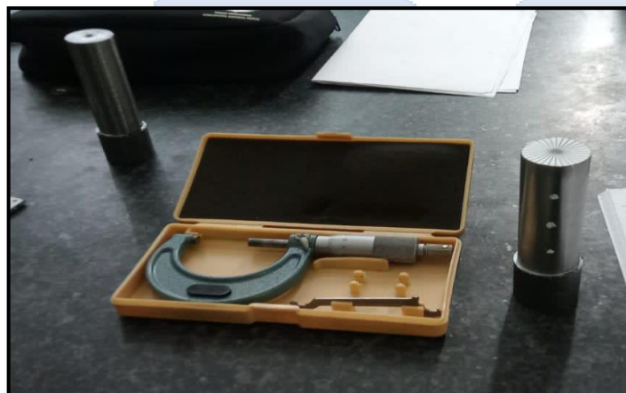
Gambar 4. 2 Mikrometer kecermatan 0,001 dan sampel uji setelah ditandai derajat
