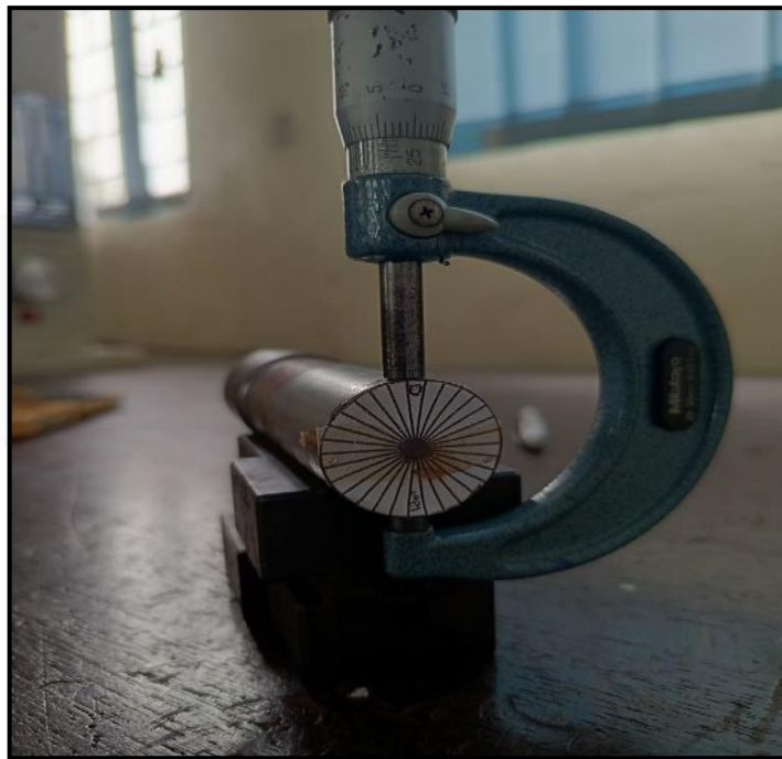
Gambar 4. 3 Proses pengukuran menggunakan mikrometer kecermatan luar 0,001 mm
