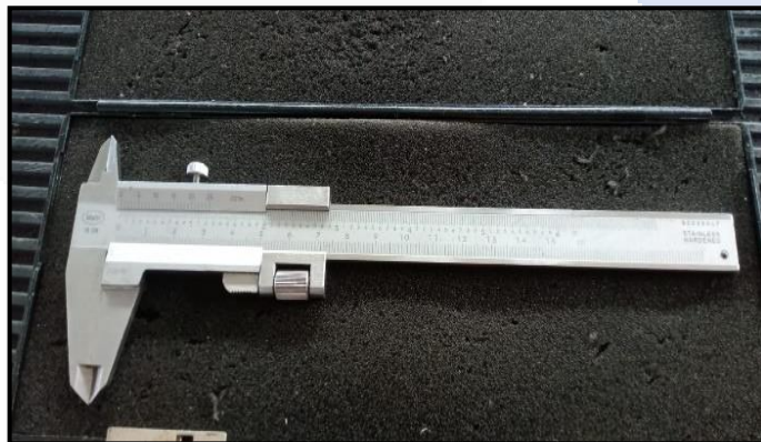
Gambar 3. 3 Jangka Sorong Kecermatan 0,02 mm
