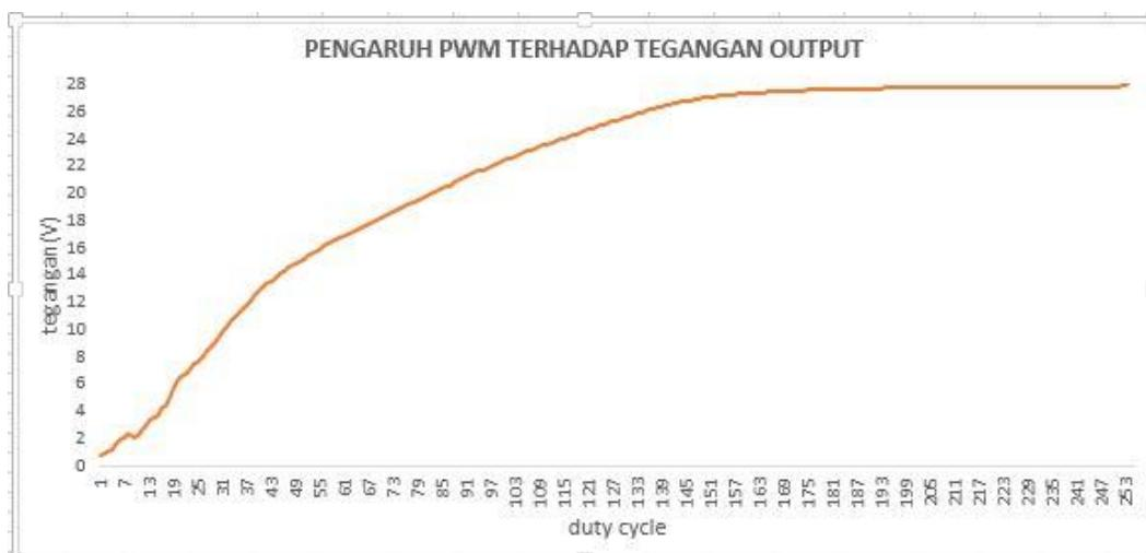
Gambar 4. 5 Grafik Pengujian Pin Enable.
