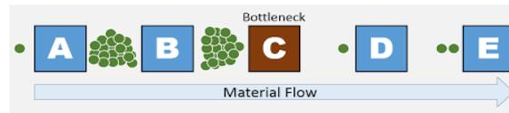
**Gambar 2.12** Ilustrasi Bottleneck dalam Flow Proses
