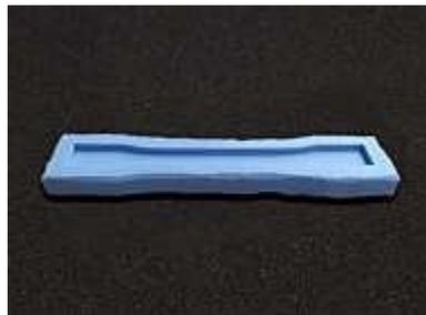
Gambar 3. 4 Cetakan Spesimen
