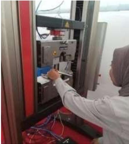
1. Memasang spesimen pada alat uji tarik.
