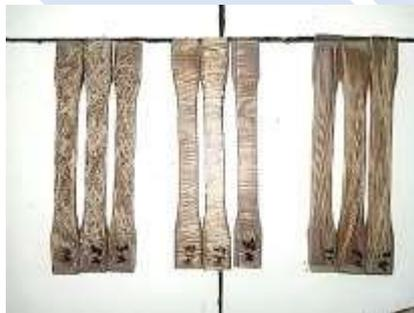
Gambar 4. 1 Spesimen Uji Tarik
