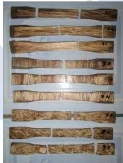
4. Spesimen yang sudah dilakukan pengujian tarik.
