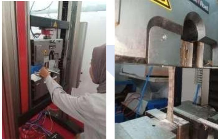
Gambar 4. 2 Proses Uji Tarik Spesimen
