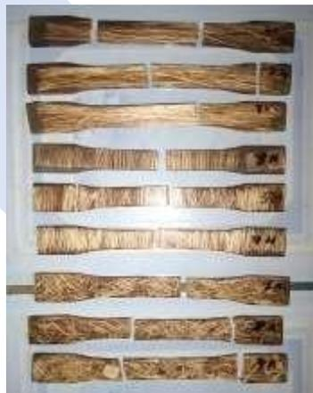
Gambar 4. 3 Spesimen setelah dilakukan uji tarik
