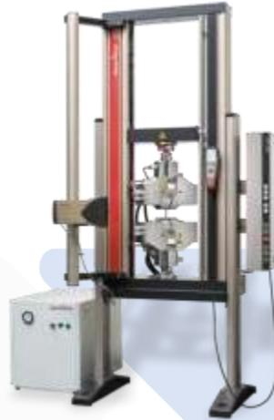
Gambar 3. 2 Mesin Uji Tarik
