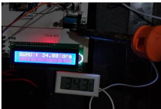
Gambar 4. 23 Pengujian sensor suhu
