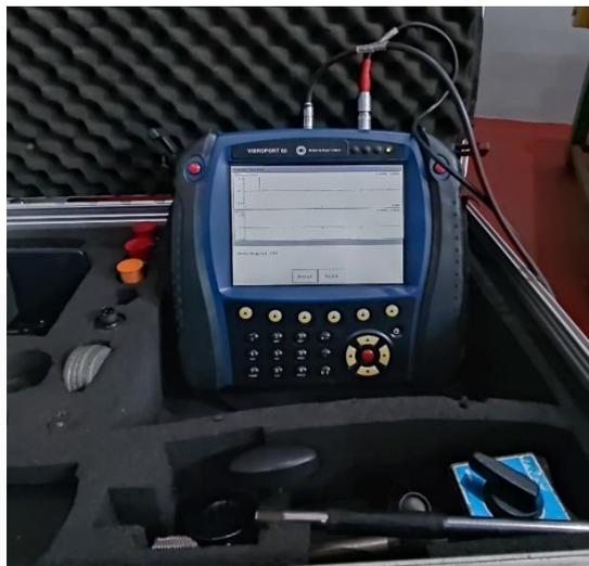
Gambar 3.6. Alat Uji *Vibroport 80*
