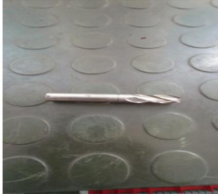
Gambar 4.14 *End Mill Ø8*
