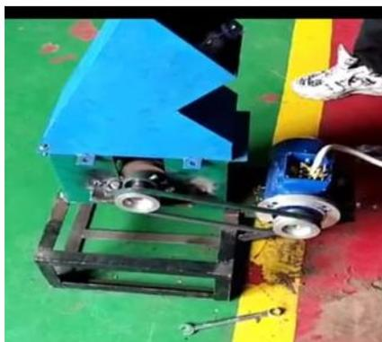
Gambar 2.2 Mesin Pencacah Plastik
