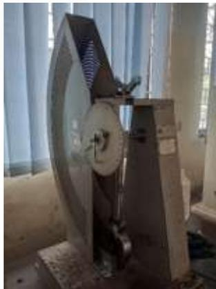
Gambar 3. 5 mesin uji impact
