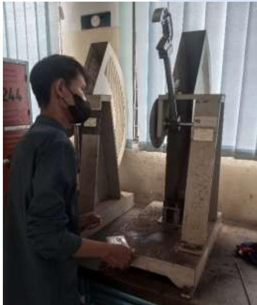
Gambar 4. 4 proses pengujian impact
