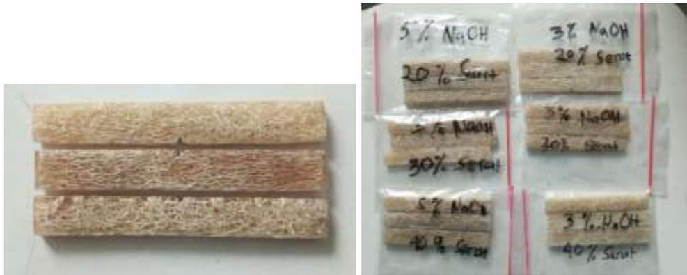
Gambar 4. 3 spesimen uji impact
