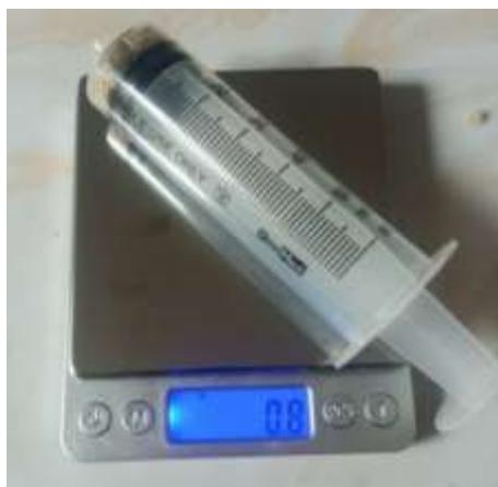
Gambar 4. 2 proses menghitung massa jenis serat gambas
