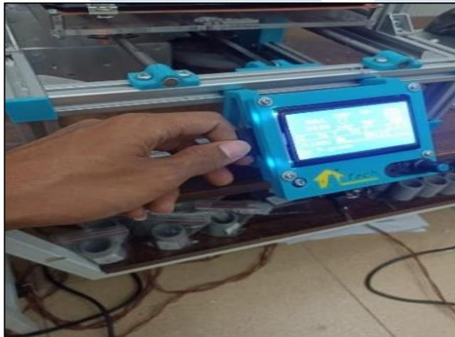
Gambar 4.5 Memasukan *Sandisk* Ke Mesin
