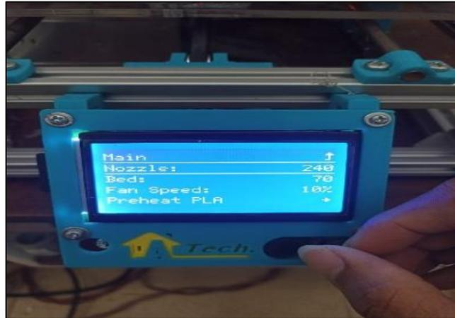
Gambar 4.6 Mengatur Parameter Proses Pada Mesin 3D *Printing*
