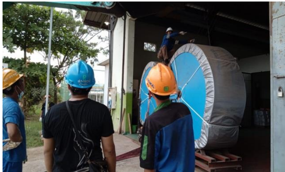
Gambar 2.7 Proses awal pemindahan belt baru ke area conveyor 2A
