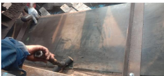
Gambar 2.20 Tekan permukaan belt yang sudah dilem dengan cara dipukul menggunakan palu karet
