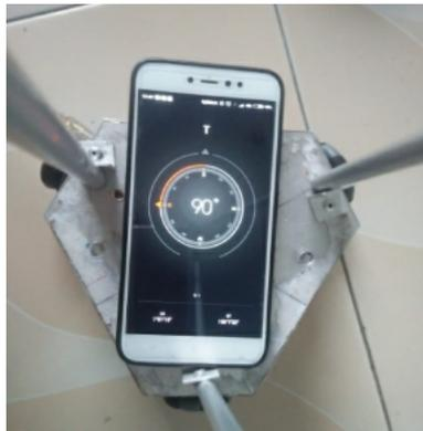
Gambar 4. 14 Hasil Pembacaan Data Sensor MPU 6050
