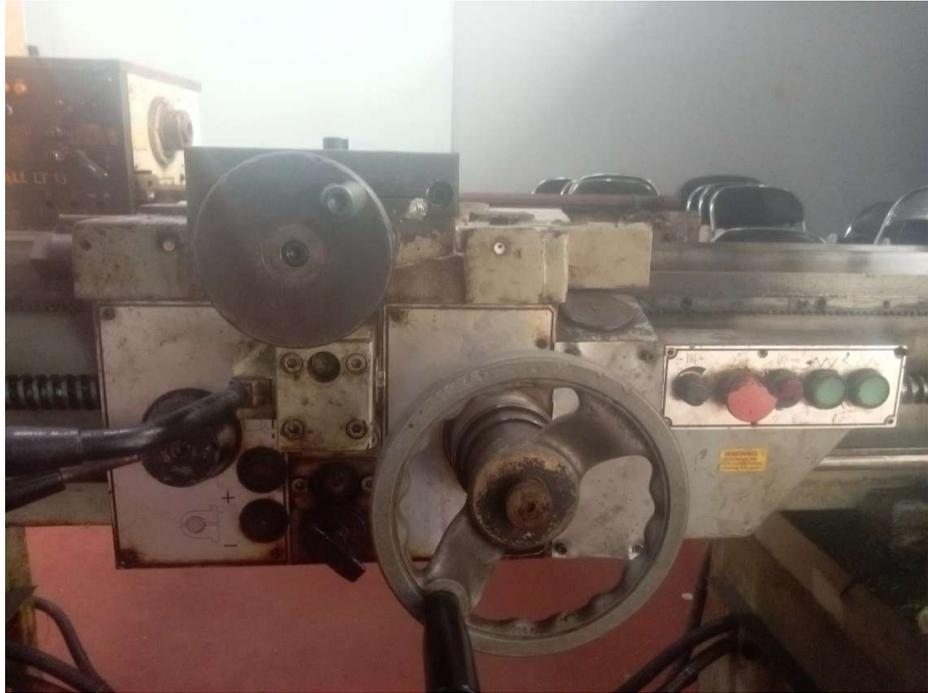
Foto kegiatan pengujian geometris eretan dan *backlash handwheel* eretan memanjang
