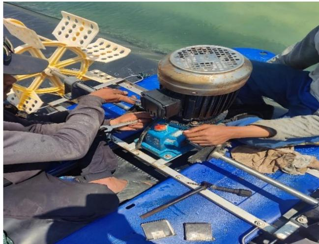
Gambar 2. 1 Perbaikan Mesin Kincir Air
