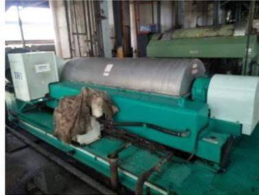
Gambar 2.19 Mesin decanter
