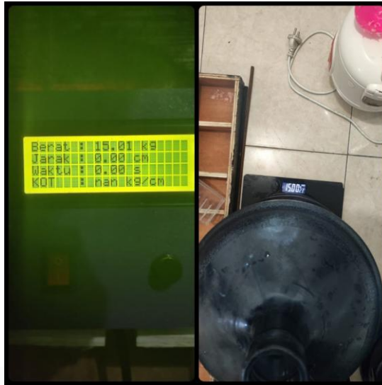
Gambar 4. 29 Pengujian Sensor Load Cell Beban Tetap
