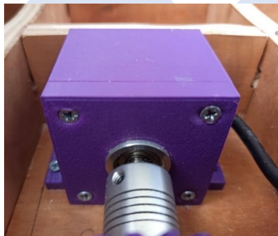
Gambar 4. 27 Peletakkan Sensor Rotary Encoder
