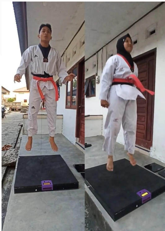
Gambar 4. 37 Pengujian Keseluruhan Alat Ukur Kekuatan Otot Tungkai
