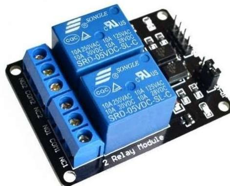
Gambar 2. 7 Relay 5V 2 Module
