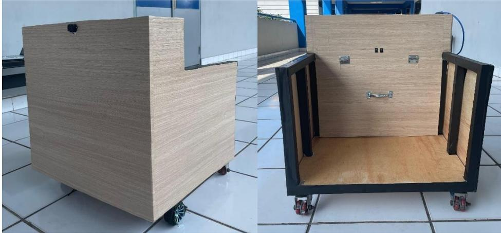
Gambar 4.2 Kontruksi Robot Keranjang Pengikut Manusia
