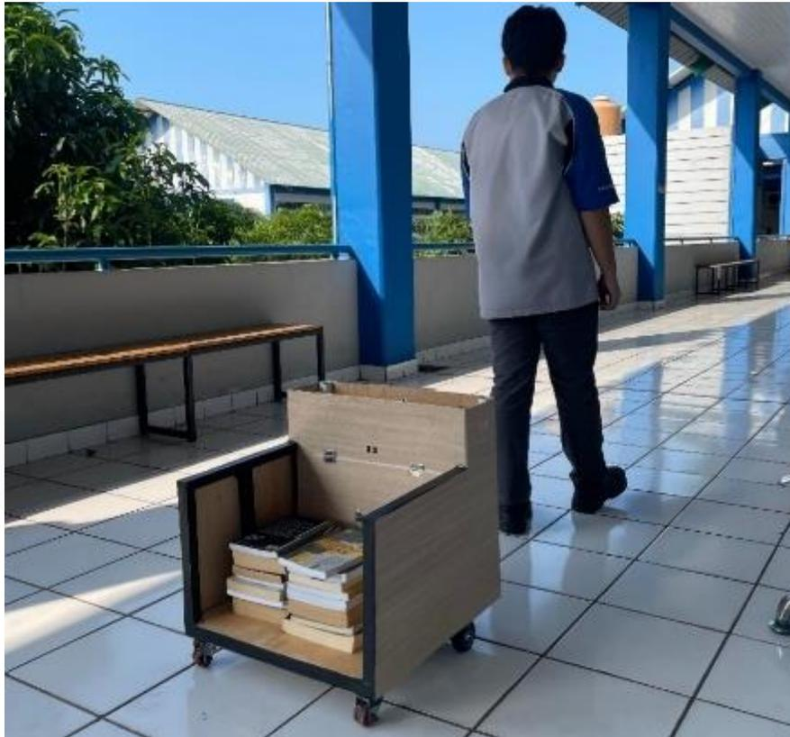
Gambar 4.16 Coba Robot Pengikut Manusia Dengan Beban
