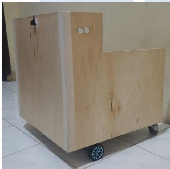
Gambar 4.4 Kerangka Robot Setelah Dipasangkan Triplek
