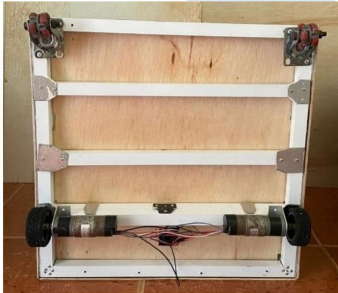
Gambar 4.5 Pemasangan Roda Robot
