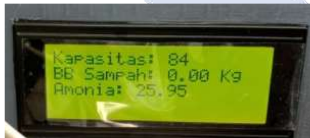
Gambar 4.1 Pengujian LCD 20 x 4 I2C
