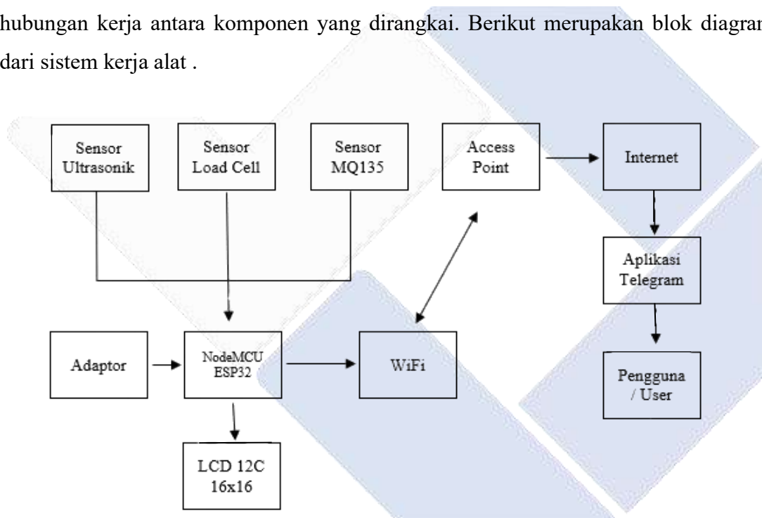
Gambar 3. 5 Blok Diagram Sistem Kerja Alat
