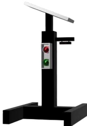
Gambar 4. 3 Desain Kontruksi Tiang *Traffic Light Portable*
