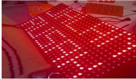
Gambar 4. 16 Hasil Pengujian Dari *Dot Matrix Display P10*
