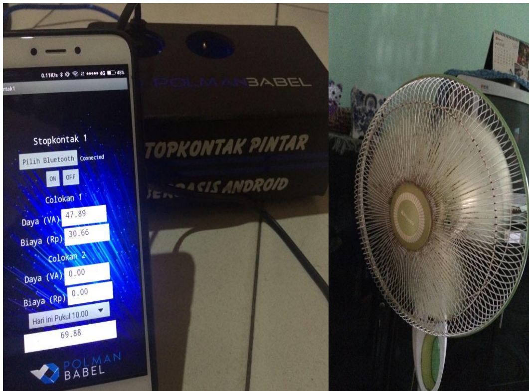
Gambar 4.17 Hasil Pengujian Stopkontak dengan beban Kipas Angin
