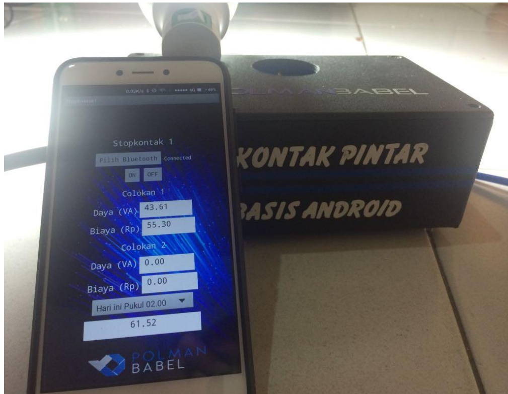
Gambar 4.16 Hasil Pengujian Stopkontak dengan beban Lampu 45 Watt
