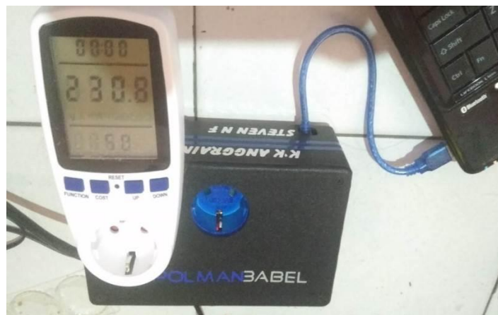
Gambar 4.3 Hasil pengukuran Tegangan pada modul sensor PZEM-004T
