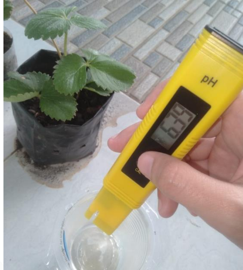
Gambar 3. 11 Pengukuran nilai ph menggunakan ph meter
