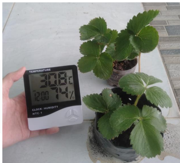
Gambar 3. 17 pengukuran temperatur udara menggunakan Humidity Meter
