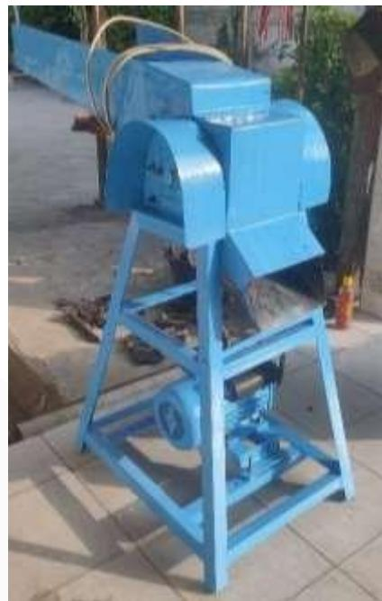
Gambar 4.8 Prototipe Mesin Pencacah
