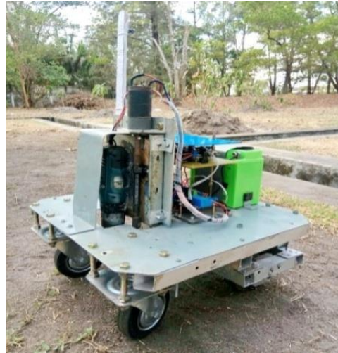
Gambar 4. 44 Hasil Perakitan Robot Pemetaan Jarak Tanam
