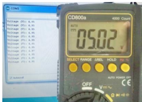
Gambar 4. 20 Hasil Pengujian 1 Sensor Tegangan DC Dengan Alat Ukur
