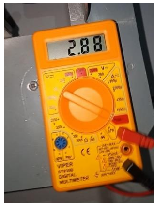
Gambar 4. 58 Pengujian Pengukuran Arus Pada Motor DC Power Window
