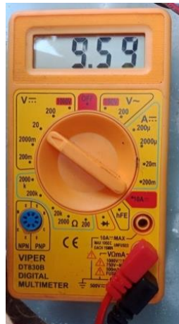
Gambar 4. 15 Pengujian Regulator IC 7810
