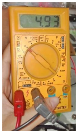
a) Pengujian MB102 5 V b) Pengujian MB102 3,3 V
