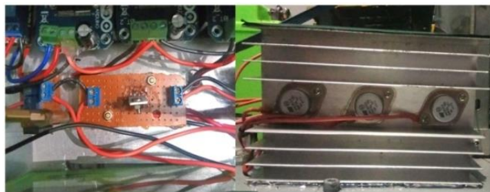
Gambar 4. 11 Hasil Pembuatan Regulator IC 7810
