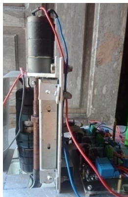
Gambar 4. 38 Pengujian Relay 2-Channel Terhadap Motor DC
