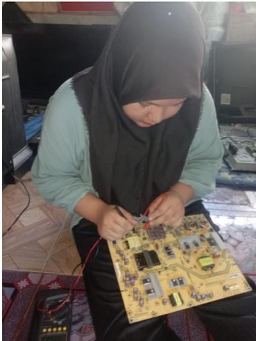
Gambar 2.12 Pengecekan Komponen PCB
