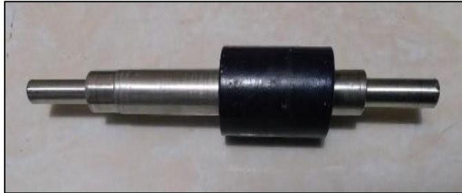
Gambar 4.8 Bentuk dari shaft pada generator
