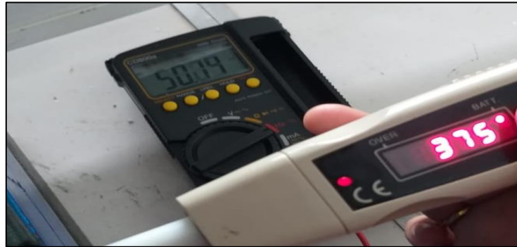
Gambar 4.6 Frekuensi yang terukur pada kecepatan 375 rpm
