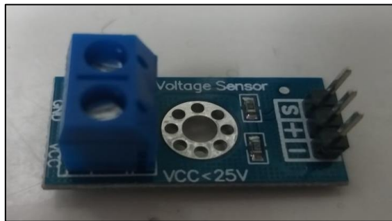
Gambar 2.6 Sensor Tegangan DC
