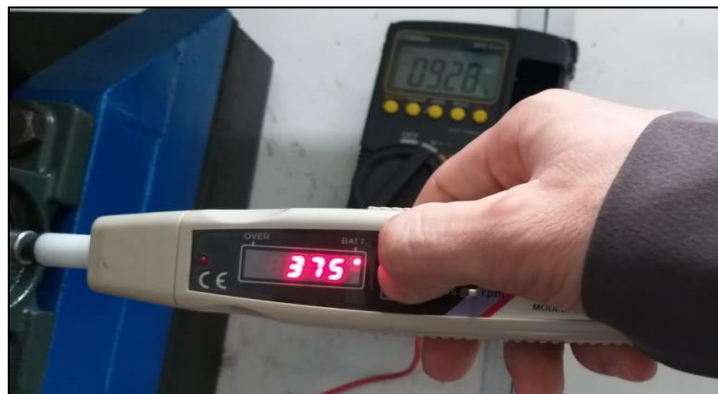
Gambar 4.7 Nilai tegangan generator yang terukur pada multimeter
