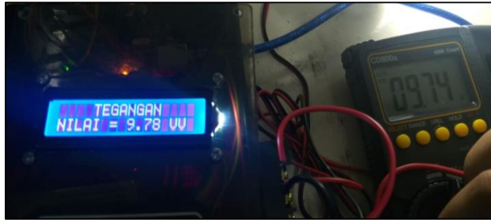
Gambar 4.18 Hasil dari pengujian sensor tegangan
