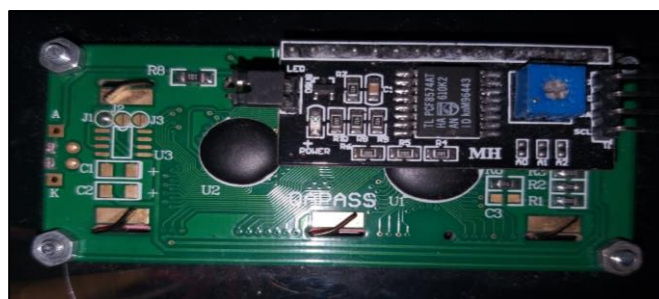
Gambar 2.8 LCD 16x2 dengan I2C yang telah dipasangkan
