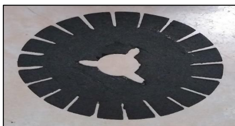
Gambar 4.11 Bentuk dari piringan pembacaan rpm
