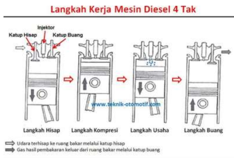
Gambar 1. 7 Langkah Kerja Mesin Diesel
