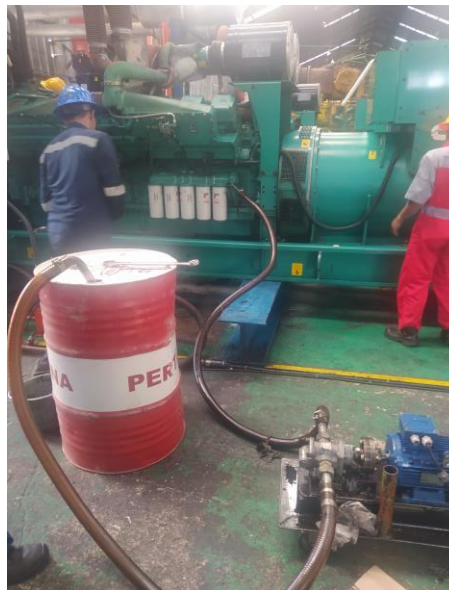
Gambar 2.4 Kegiatan Mengganti Oli Mesin Cummins 1
