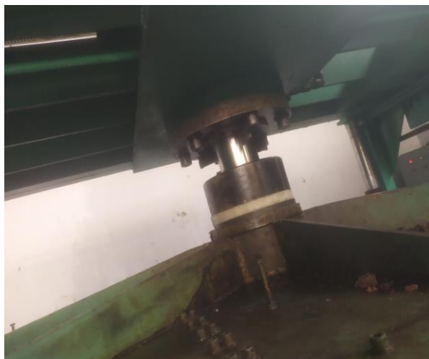
Gambar 10. Pemasangan Silinder Hidrolik Pada Mesin Press Recycle
