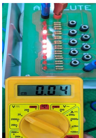
Gambar 4.20 Hasil Pengukuran Tegangan Absolute Pada Logika Rendah
