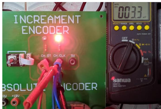
Gambar 4.13 Hasil Pengukuran Tegangan Increment Pada Logika Tinggi
