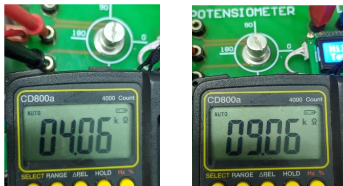
Gambar 4.7 Hasil Pengukuran Nilai Tahanan Potensiometer
