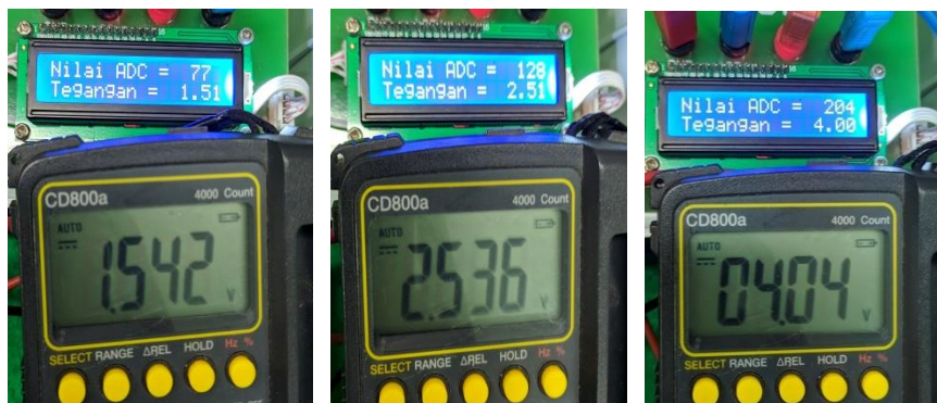
Gambar 4.5 Tampilan LCD Nilai ADC dan Tegangan
