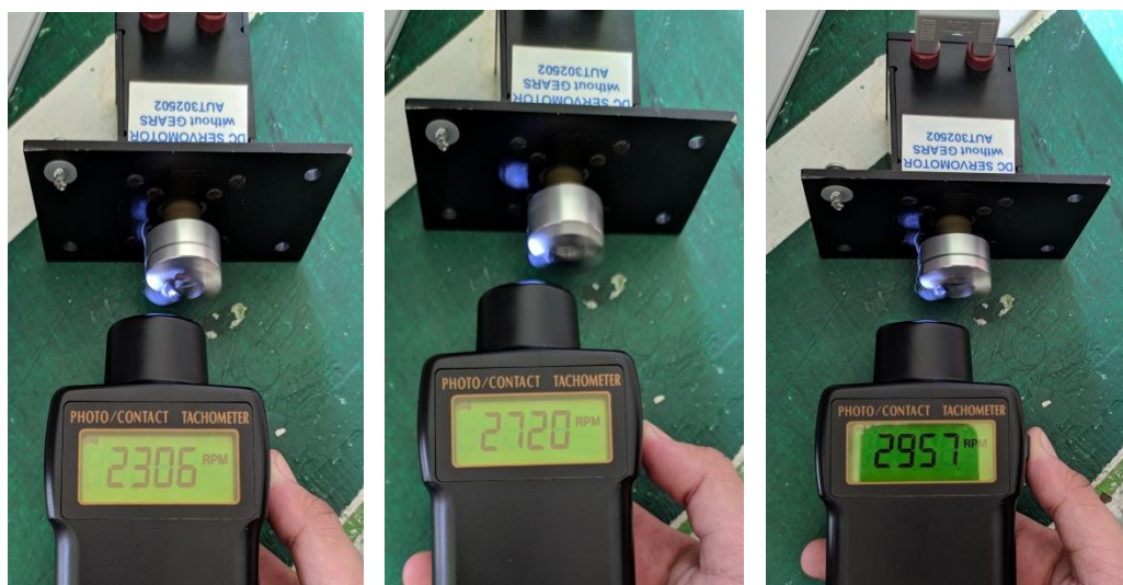
Gambar 4.30 Hasil Pengujian Kecepatan pada PWM 30 % 50% 100%
