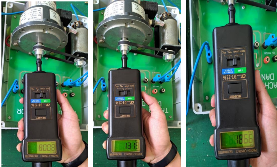
Gambar 4.35 Hasil Pengujian Kecepatan Motor dengan dutycycle 150, 200 dan 255
