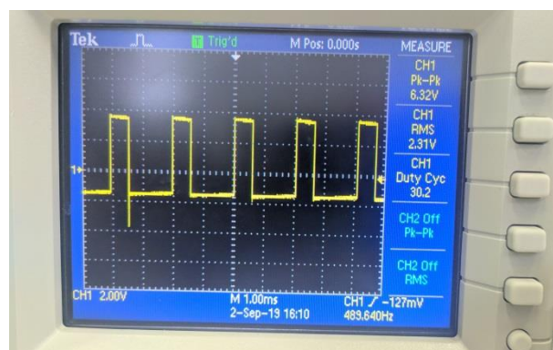
Gambar 4.26 Sinyal PWM dengan dutycycle 30,2%
