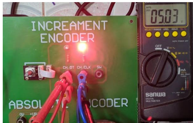
Gambar 4.12 Hasil Pengukuran Tegangan Increment pada Logika Rendah
