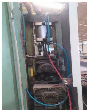
Gambar 2. 15 Silinder pneumatik plat penyeting silinder penekan horizontal
