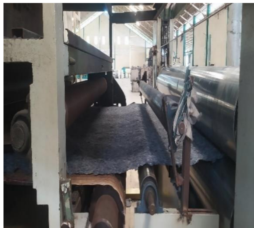
Gambar 2. 14 Material masuk ke silinder penekan horizontal
