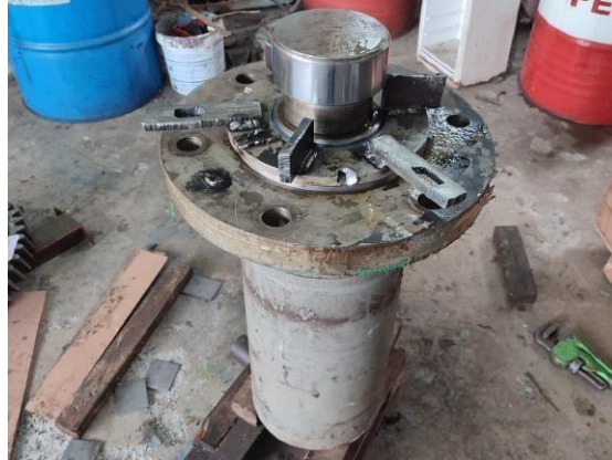
Gambar 2. 6 Pemasangan Seal Pada Silinder Hidrolik
