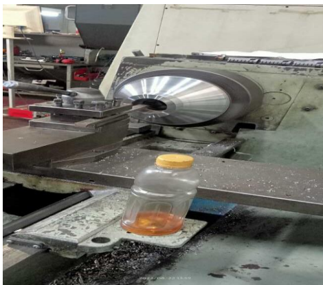
Gambar 2.3 Pembubutan Cone Dudukan Mesin
