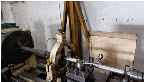
Gambar 2.1 Pembubutan Shaft Propeller
