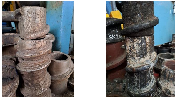
Gambar 2. 11 Worm Yang Belum Di Repair dan Sudah
