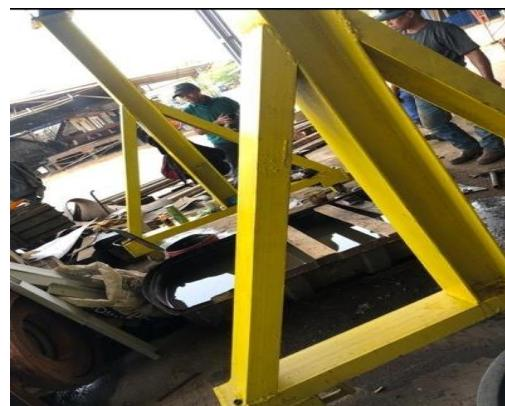
**Gambar 2.5 Besi UNP pada gantry crane**
