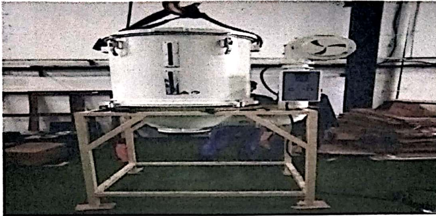
Gambar 1.07 Uji Coba Dudukan Hopper
