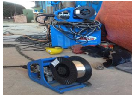
Gambar 1.10 MIG ARC WELDING STEEL/ ALUMUNUM
