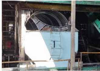
Gambar 1.5 Mesin Perontok dan pelumatan buah( Thresher )
