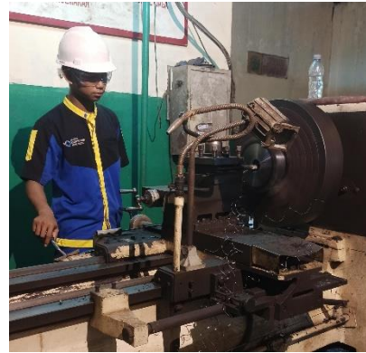
Gambar 2.10 Proses pembubutan diameter dalam Gear Sprocket
