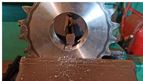
Gambar 2.11 Proses Penyekrapan pembuatan Jalur spit
