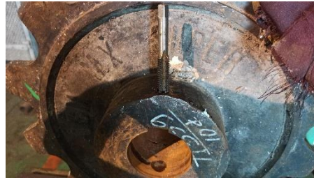
Gambar 2.12 proses Pengetapan Gear sprocket Conveyor ICBC
