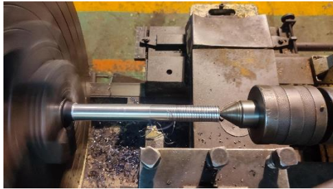
Gambar 2.9 Membubut dan pembuatan ulir as basculator
