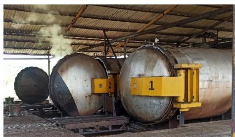
Gambar 1.4 Mesin perebusan( Sterelizer )
