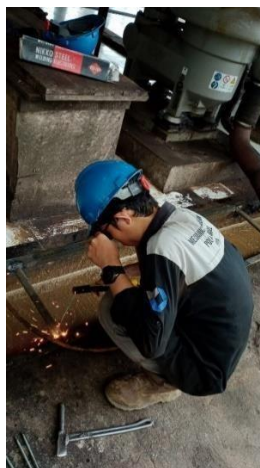
Gambar 2.3 Fabrikasi tutup parit pome stasiun klarifikasi
