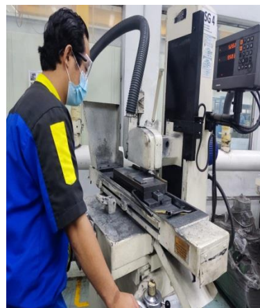
Gambar 2. 14 Proses Sharpen mata potong yang sudah di wire cut
