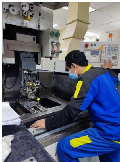
Gambar 2. 4 Proses setting pada mesin wire cut
