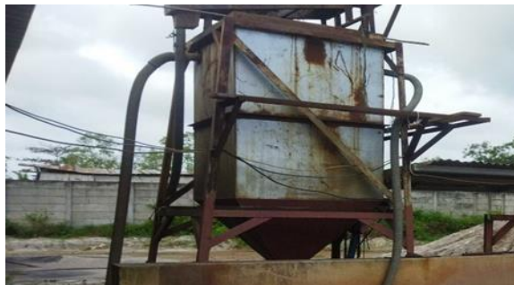
Gambar 2. 4 Hopper olahan HTS yang gagal
